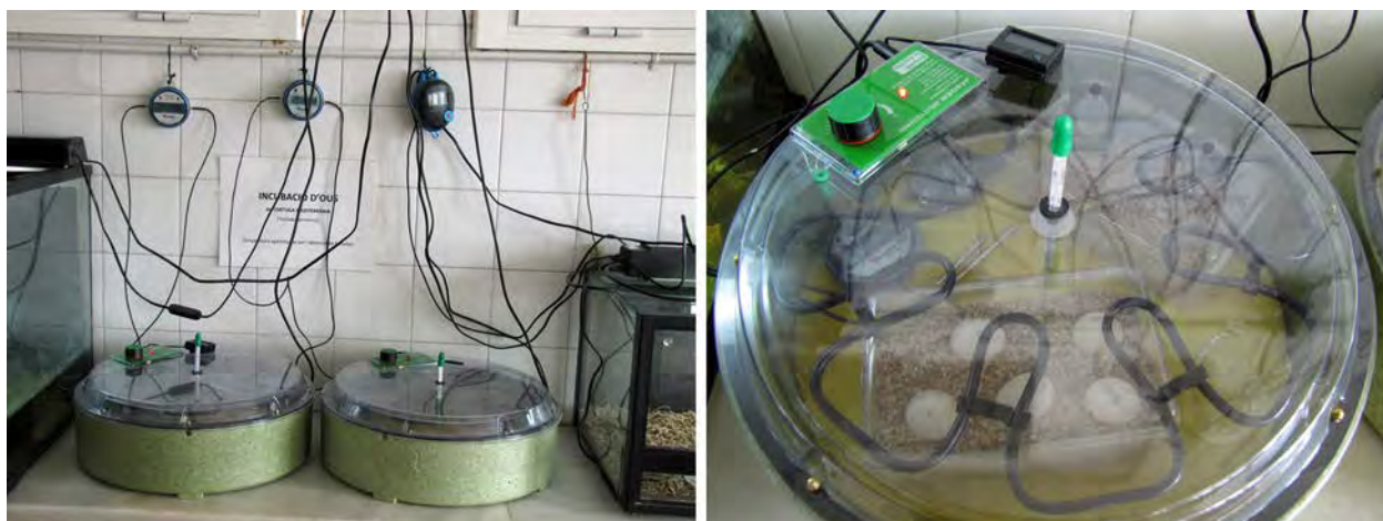
Figura 18. Muntatge de les dues incubadores Jaeger i la seva ubicació entremig de l'aquaterari i del terrari interior de les tortugues al laboratori de biologia de l'escola. A la dreta, visió superior d'una d'elles en la que es pot apreciar, a través de la tapa transparent, el serpenti de la resistència calefactora, les caixes d'incubació amb els ous i un sensor interior. En la part exterior el reòstat que permet graduar el termòstat i un higròmetre.
