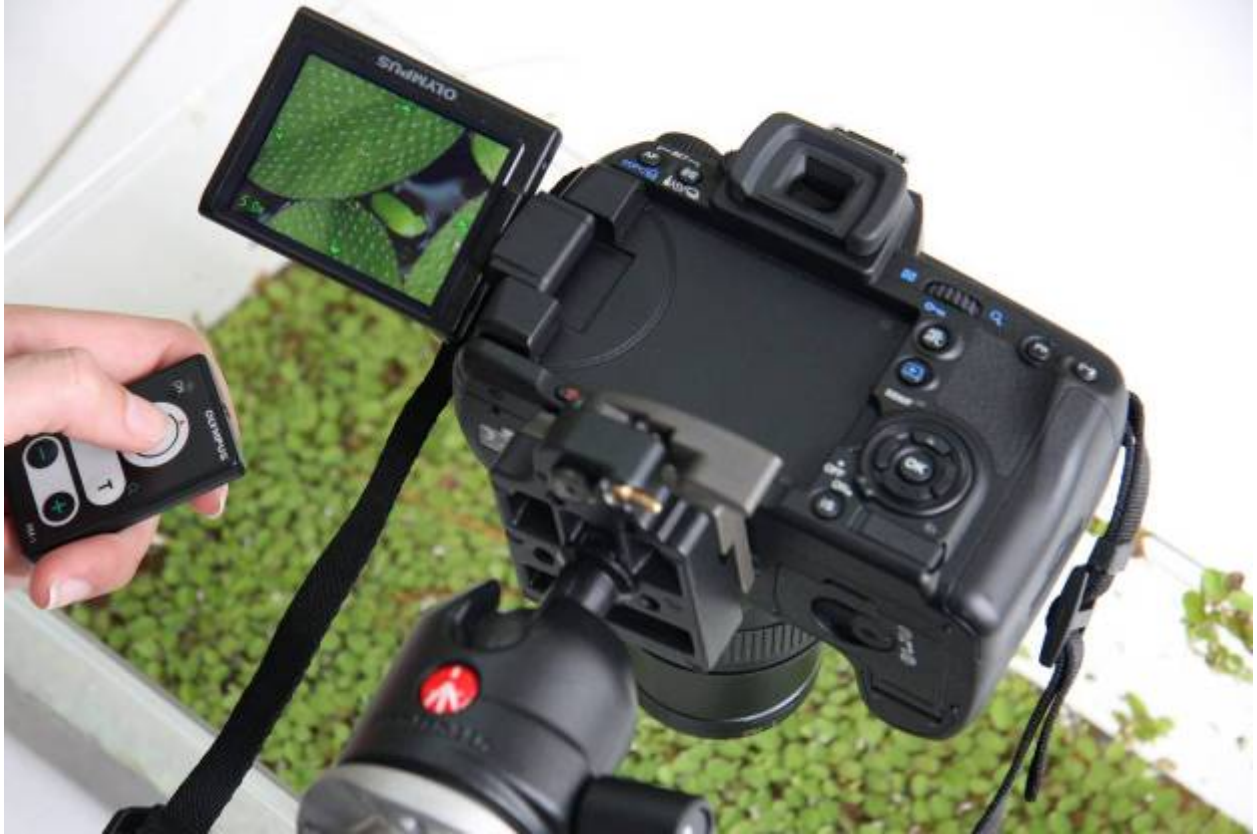
Figura 20: En aquesta imatge es veu cada una de les avantatges de les funcions esmentades: pantalla live view , orientable, lupa d'enfocament (es pot observar que la imatge de la pantalla és sensiblement més gran que l'objecte), i el comandament a distància.
