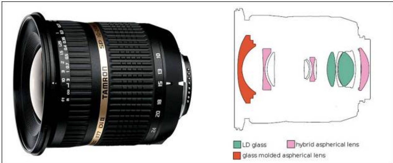
Figura 14. A l'esquerra fotografia de l'objectiu zoom angular extrem utilitzat en aquest treball, en el que es pot observar la corbatura de la lent frontal. A l'esquema de la dreta s'indiquen les lents que tenen corregida l'aberració d'esfericitat. (Extret de http://www.tamron.eu/en/lenses/technical-glossary.html?tx_keshowa21glossarylist_pi1[char]=A&cHash=9d39926938#aspherical ).
