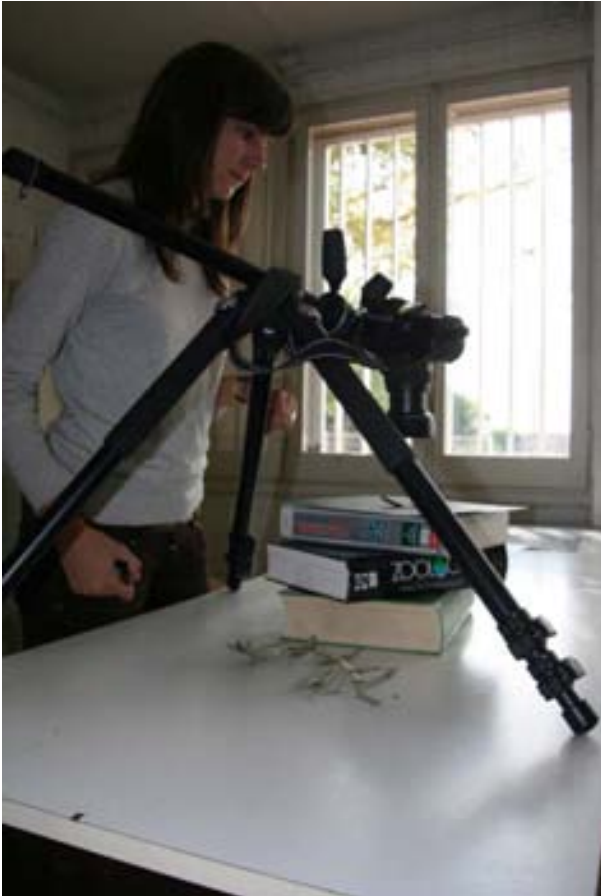
Figura 5.3. Trípod amb barra transversal i d'un elevat grau d'obertura de les potes (la tercera pota, la que no es veu on acaba, arriba al terra).
