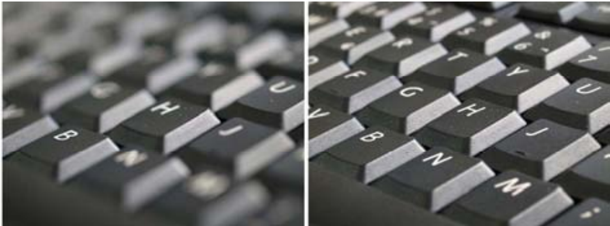
Figura.3.2. Fotografies que il·lustren l'efecte de l'obertura del diafragma (esquema igual al dibuix de la figura anterior) en la profunditat de camp. La imatge de l'esquerra correspon a un diafragma molt obert ( f/2.0 ), mentre que en la de la dreta és bastant tancat ( f/11 ). Amb un temps d'exposició de 1/20 segons i 1,6 segons, respectivament (es va fer ús del trípode).
