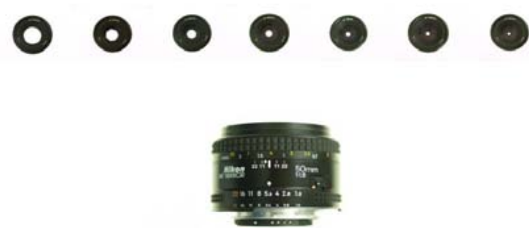
Figura.2.9. La majoria dels objectius mostren els diafragmes disponibles en el barrilet. L'obertura més gran ve representada pel número f menor i l'obertura més petita pel número f major (imatges reals a partir de fotos d'un objectiu Nikon separat de la càmera i col·locat a sobre d'un banc de llum al laboratori de fotografia. D'esquerra a dreta, des de la màxima obertura (f/1.8) a la mínima (f/22)).
