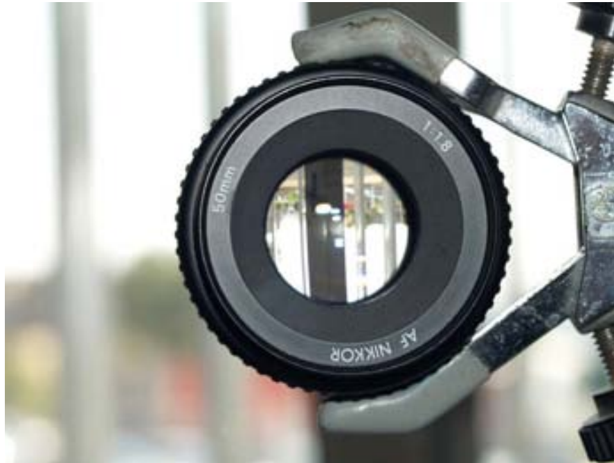
Figura 2.10. Visió frontal d'un objectiu, separat de la càmera i amb el diafragma obert al màxim) en el que es pot observar les inscripcions de longitud focal (50 mm) i màxima obertura o lluminositat ( f/1.8 ).
