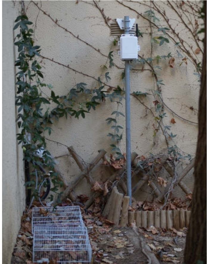
Figura 18. Subestació meteorològica del pati de les tortugues, al costat de les caixes-refugi on hibernen les tortugues. Al fons a l'esquerra, entre la planta enfiladissa s'entreveu el datalogger Escort amb la doble sonda de temperatura (la superficial i la que està enterrada a nivell de les tortugues).
