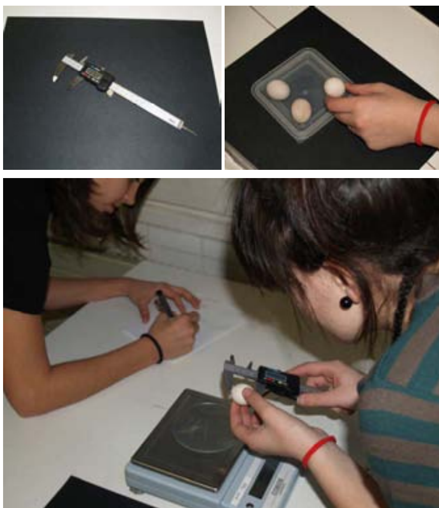
Figura 26. En les fotos superiors es veu, a l'esquerra, el peu de rei digital amb el qual es van mesurar els ous, tant d'ample com de llarg, i a la dreta d'aquesta es veuen tres dels 4 ous, els quals ja estaven pesats i mesurats. En la foto de sota es veu com estem mesurant els ous amb el peu de rei, i la tècnica que es va utilitzar.
