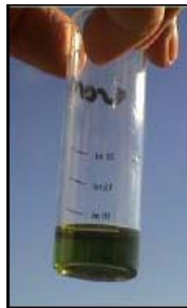
Fig. 35. Obtenció mitjançant un producte Sera de la duresa de l'aigua
