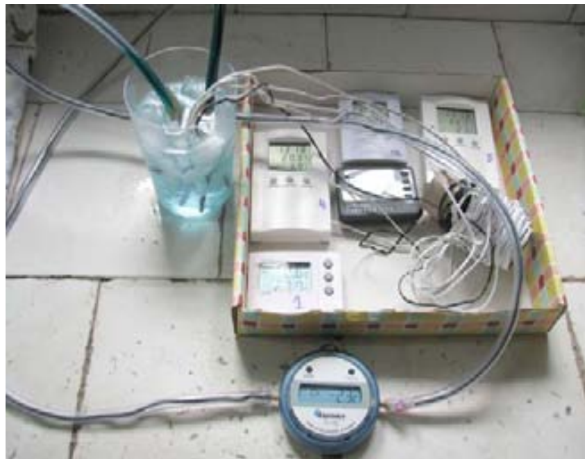
Fig. 19. Muntatge per al calibrat de les sondes amb el sensor T3 ilog (en primer terme). Es va utilitzar una barreja d'aigua amb alcohol (que s'havia mantingut al congelador) per les temperatures baixes.
