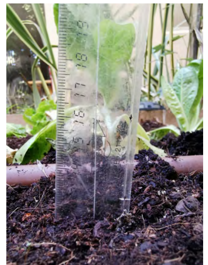
Figura 7. Detall del dispositiu per situar els sensors a la profunditat desitjada.
