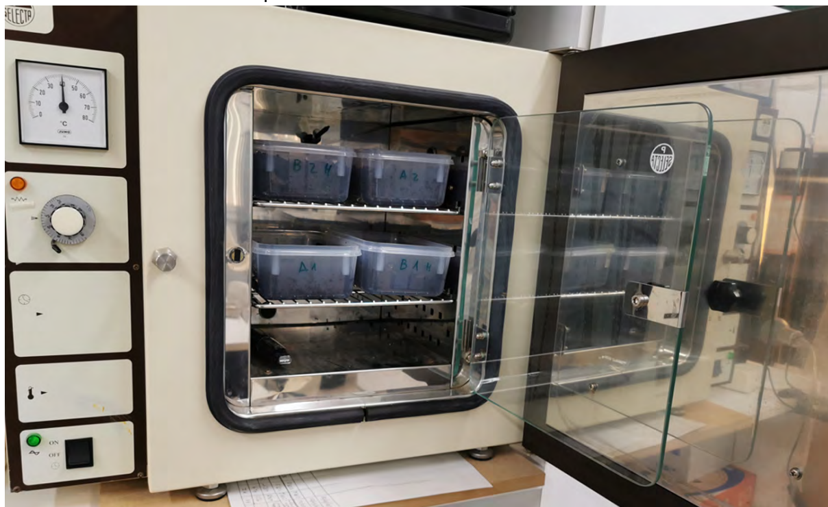
Figura 11. Estufa de cultiu en la que es pot veure la disposició creuada dels 4 recipients.
