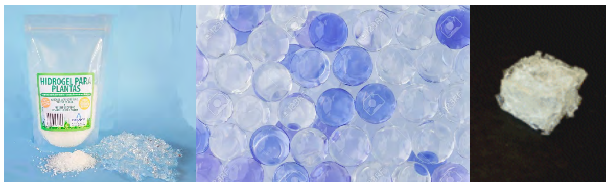
Figura 5. En les imatges s'hi pot observar els tres tipus d'hidrogel: en pols (esquerra) , esferes hidratades (centre) i xerogels (dreta) (imatge extreta de Bernat Ferrer, 2020).
