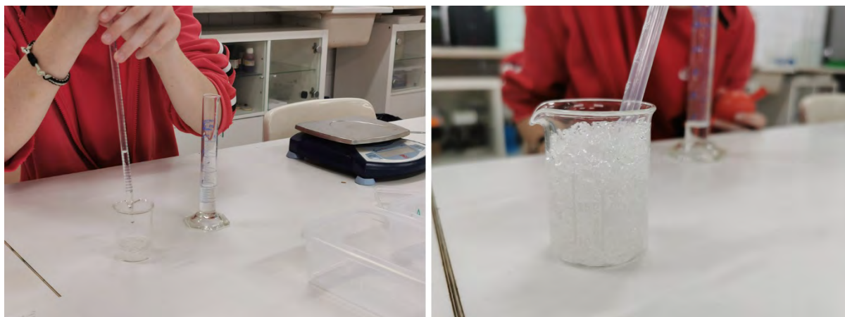
Figura 9. Primera prova sobre la capacitat de retenció d'aigua de l'hidrogel en pols. El recipient va resultar massa petit.
