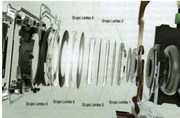
Figura 7. Exemple d'estructura de bloc òptic (objectiu) muntat en una càmera d'smartphone. (Extret de Rivas, 2015).
