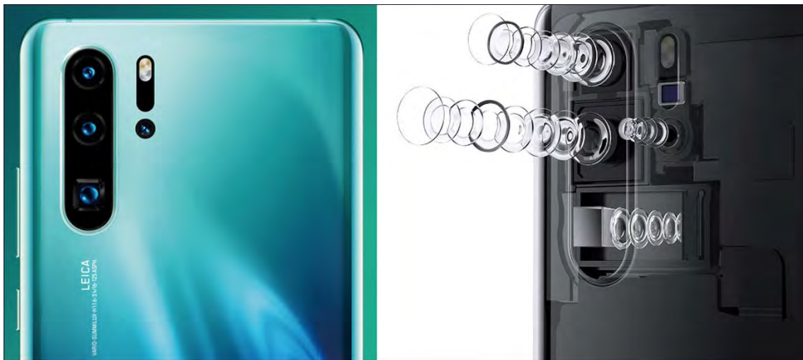
Figura 8. Detall de la distribució de les diferents Càmeres (Esquerra) i dels elements dels blocs òptics (dreta) de l'smartphone Android (Huawei P30 Pro) utilitzat en el treball.
