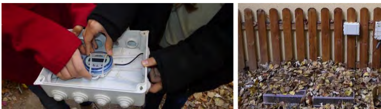
Figura 5. Detall de com es col·loquen a dins de caixes de protecció els enregistadors electrònics Escort iLog (esquerra) i la seva situació al Pati de les tortugues, molt a prop de les caixes on hibernen les tortugues (dreta). (Figura extreta de Ferran Jiménez, 2016).
