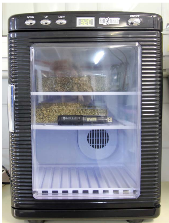
Figura 13. Càmera termoreguladora ExoTerra que hem utilitzat com a càmera freda.
