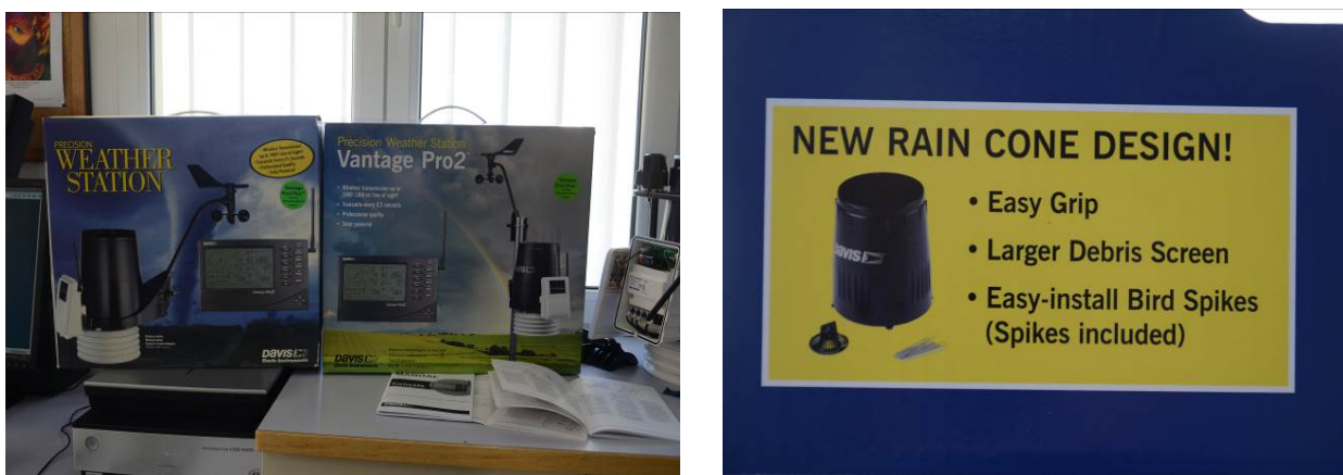
Figura 10. Nova estació meteorològica de l'escola el dia del muntatge a l'aula d'informàtica. A l'esquerra es poden comparar els dos models, l'antic i el nou. La principal novetat és que la nova incorpora de sèrie un dispositiu antiocells en el pluviòmetre (dreta).
